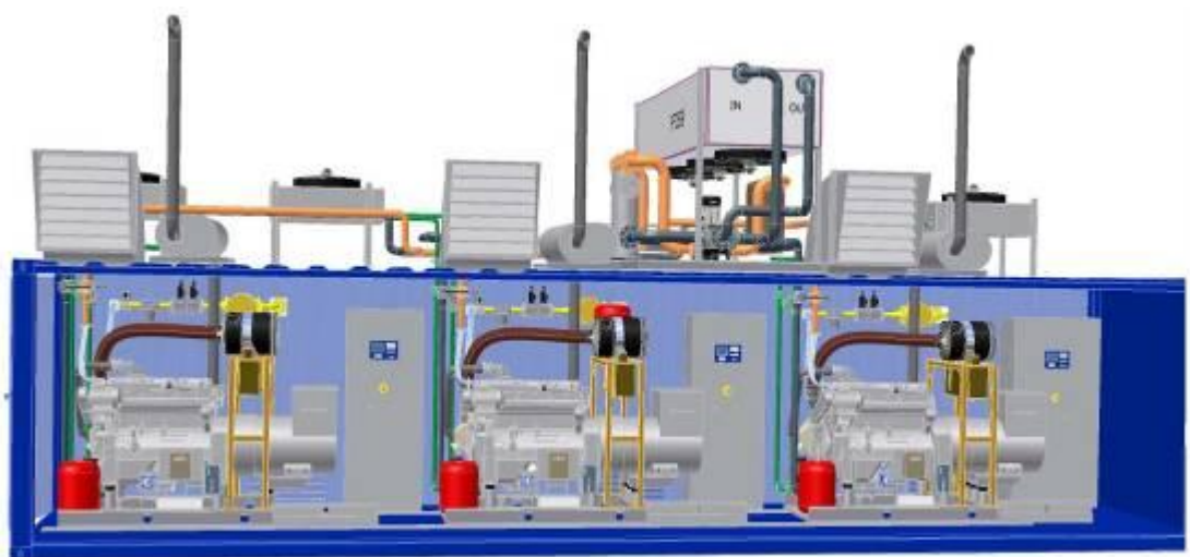
Kogenerační jednotka je srdcem bioplynové stanice
